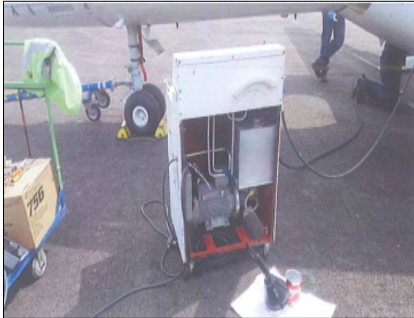
Fotografía No. 15: Equipos utilizados para realizar prueba hidráulica HK4394
