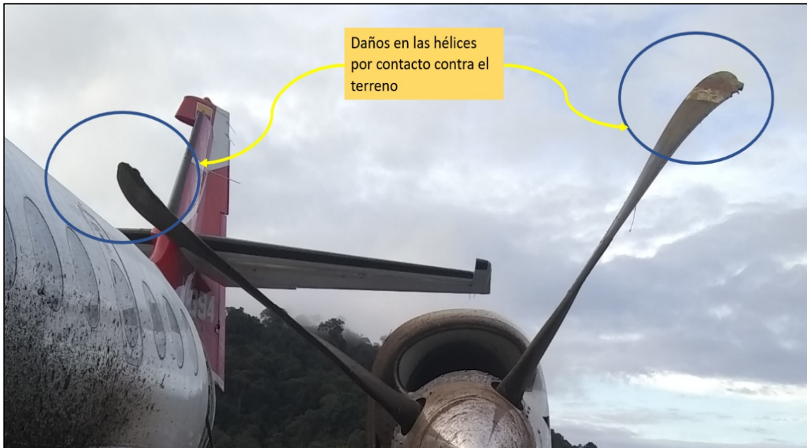
Fotografía No. 6: Estado final de las palas de hélice HK4394
